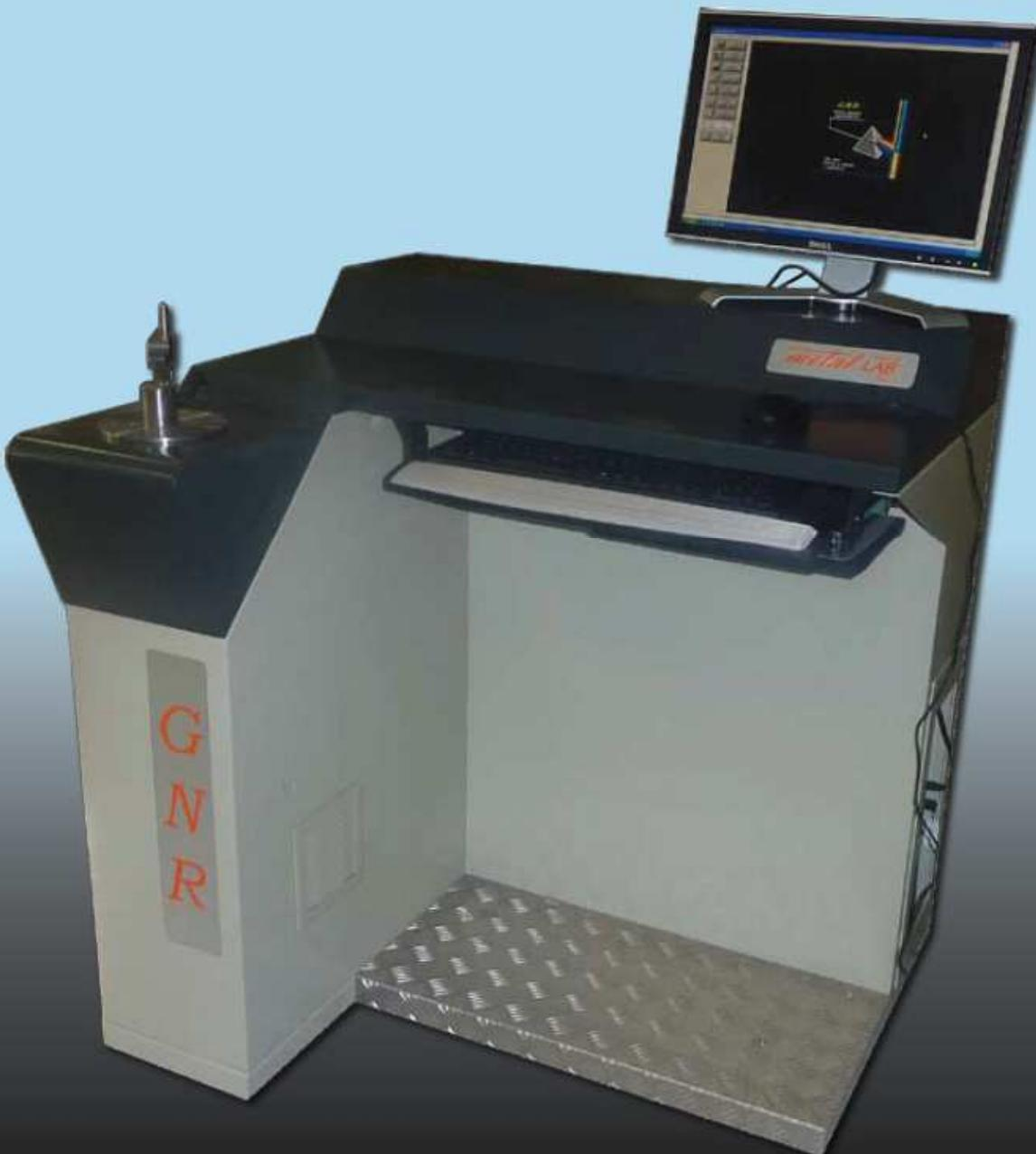
G.N.R. freut sich Ihnen das neue METAL LAB PLUS vorstellen zu dürfen - die ideale Lösung für die optische Emissionsspektrometrie in Form einer Labor-Arbeitstation.
